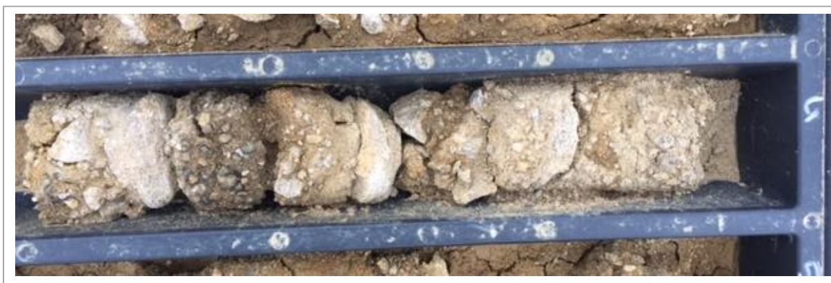
Figura 14 – Particolare di alcuni sottili livelli calcarenitici – Sondaggio S1 (m -3.5 - -4.0)
