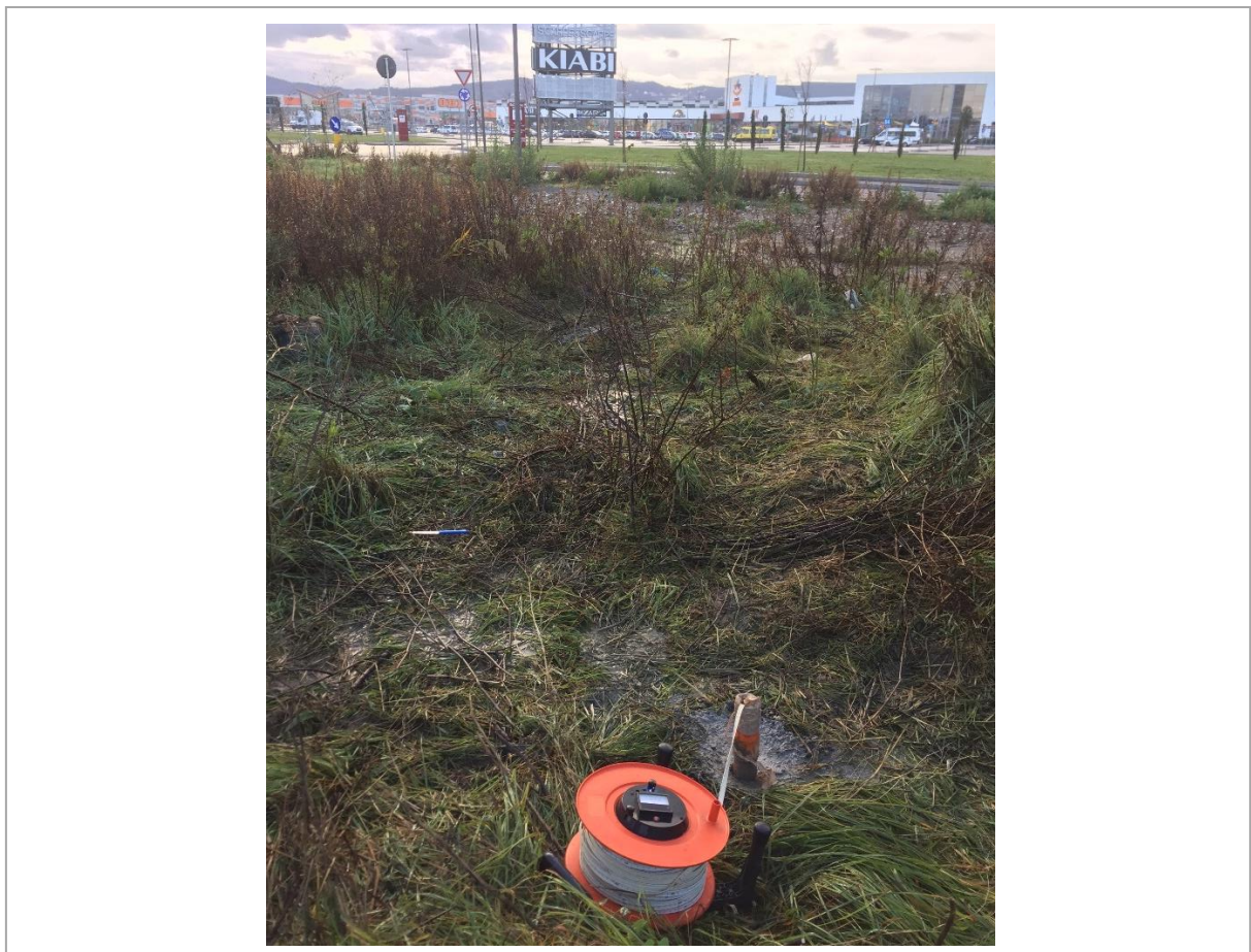
Figura 10 – Misure di soggiacenza della falda in corrispondenza del piezometro PzS1
