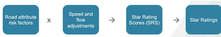
Figura 4 – Modello schematico di calcolo dello Star Rating
