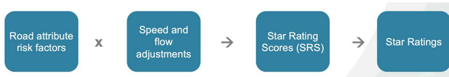
Figura 4 – Modello schematico di calcolo dello Star Rating
